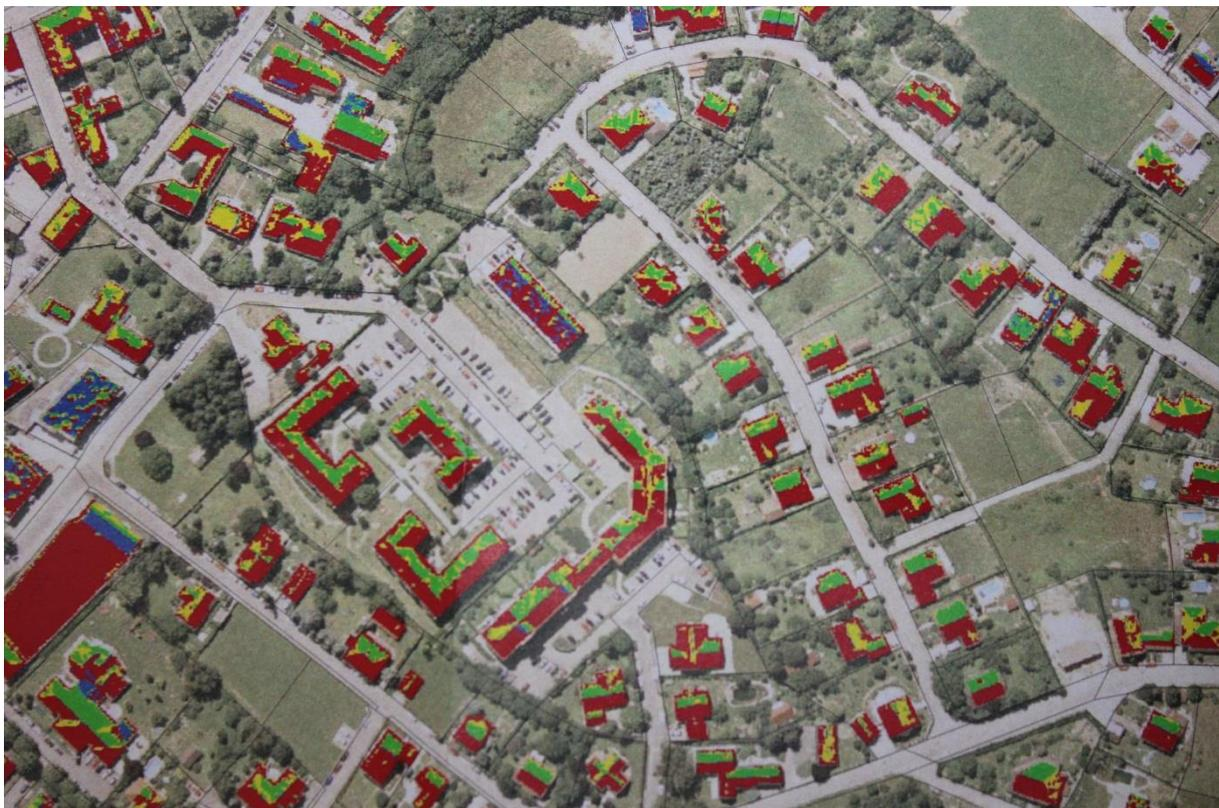
**Bild:** Grafik zum Ergebnis der Sonnenkraftpotenzial-Analyse. Die Rot eingefärbten Dächer weisen eine optimale Lage zur Sonne auf und besitzen dadurch ein besonders hohes Potenzial für die wirkungsvolle Installierung einer Photovoltaikanlage. Grün und Blau gefärbte Dächer sind weniger für die Anbringung einer Photovoltaikanlage geeignet.
